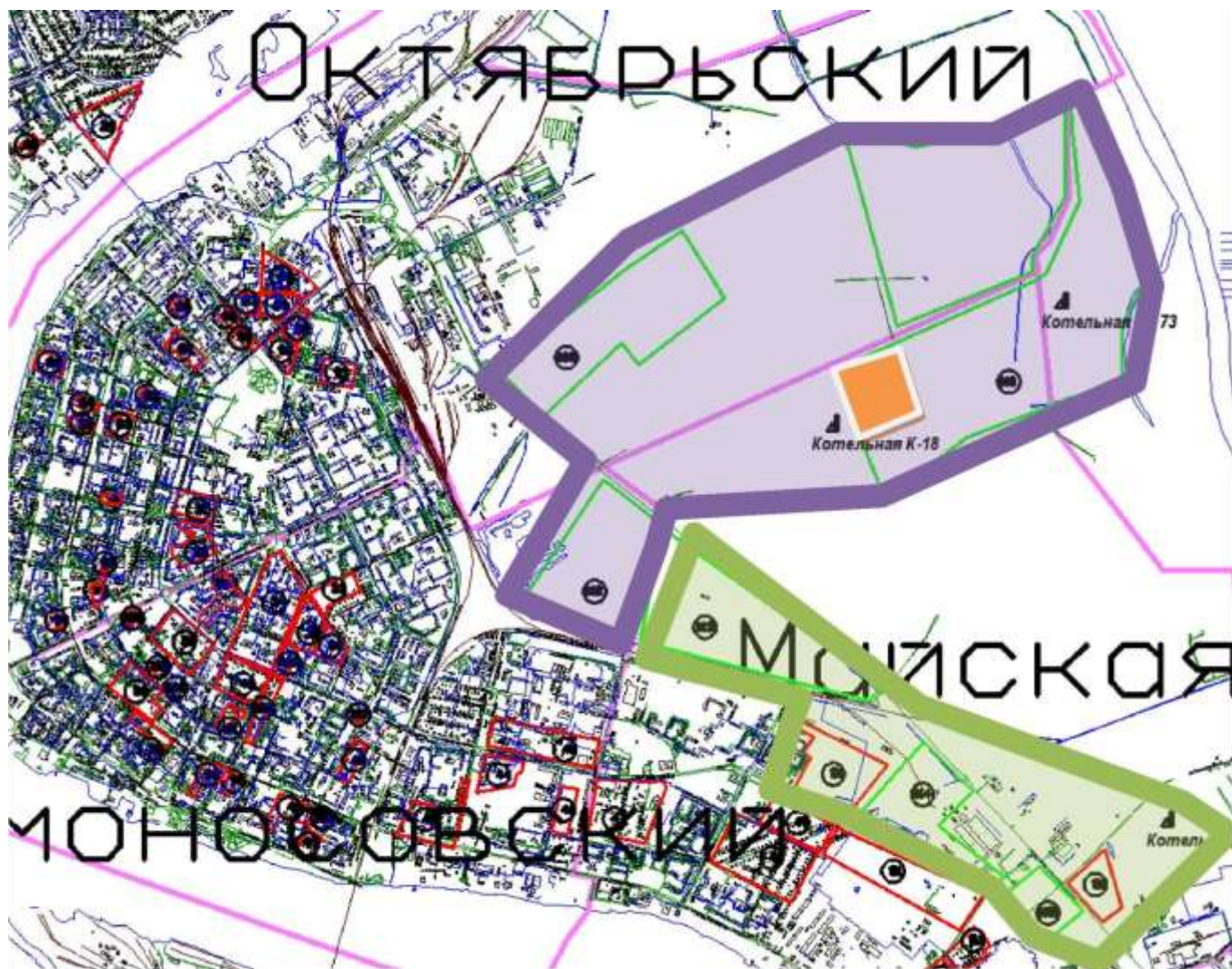
Рисунок 3.2 - Зоны действия предлагаемых к строительству котельных
